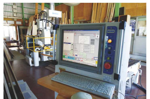
NCルーターのプログラム入力用コンピューター
