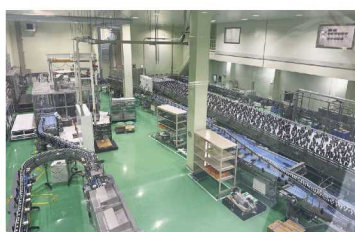
令和元年にできた第8製造工場の内部。 充てんされたペットボトル飲料が ベルトコンベアで運ばれている
