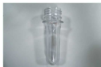
約500ml用ペットボトルのプリフォーム。 約100度に温めて、中に高压の空気を 入れて金型に合わせて膨らませる
