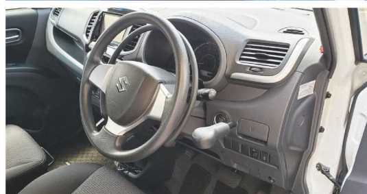
アクセルリングやブレーキレバーを取り付けた改造車両
